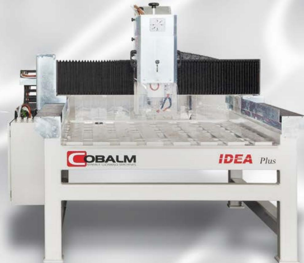
Numerisch gesteuerter Pantograph für Marmor, Granit und Keramik.
