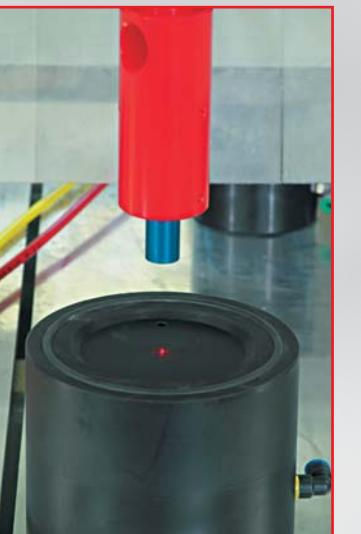
● Puntatore laser per facilitare il posizionamento di battute e ventose.
