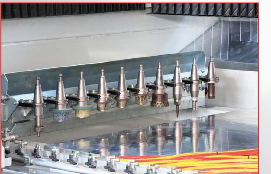
● Magazzino portautensili 12+12. (Macchina 4 assi 10+10).
